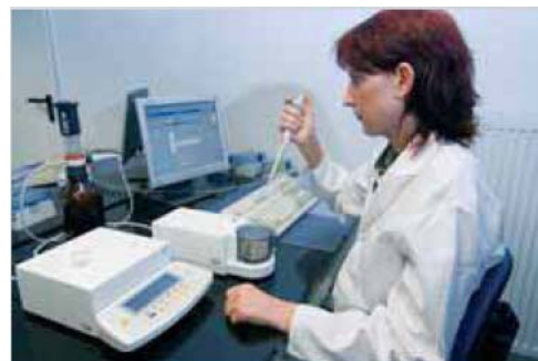
Webers 服务组成员演示进行移液器校准的常规工作
