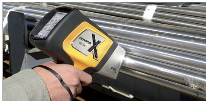
强大的DELTA手持式X射线荧光分析仪在判断合金和金属的ID牌号操作中可以最大程度地提高检测速度和检测精度，从而使质量控制和质量保证、安全及维护等工作得以顺利进行。
