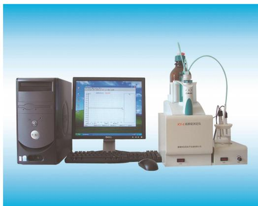
**KY-4S 硫醇硫测定仪**应用全自动电位滴定原理，在计算机控制下，实现石油产品中硫醇硫含量的分析测定。仪器采用进口滴定单元，对滴定曲线进行平滑处理，对滴定终点位置进行修正，保证了结果的准确性。是石化实验室、分析室和科研部门的必备仪器。
